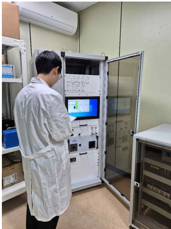
[사진2] KTL 진주본원 굴뚝배출가스 가스 항목 연속자동측정기 실내 시험장면 (경남 진주시 소재)
