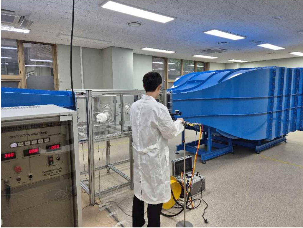
[사진1] KTL 진주본원 굴뚝배출가스 유속자동측정기 실내 시험장면 (경남 진주시 소재)
